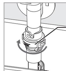
❗ロックを完全に外さないままコネクターを下げると部品が破損します
